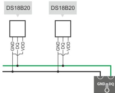
Abb. 33. Anschließen von 1-Wire-Sensoren an PQM-750.
