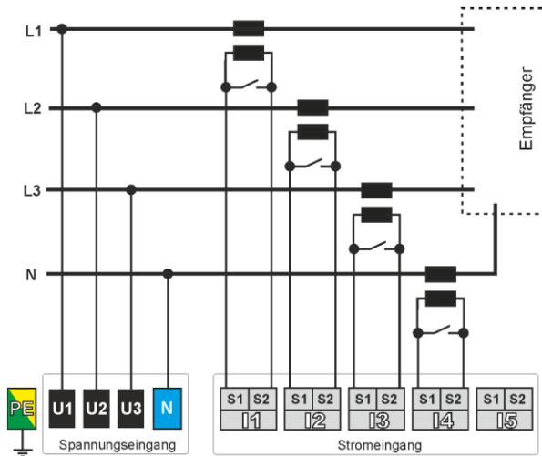
Abb. 27. Anschlussplan – 3-Phasen-4-Leitersystem, Direktanschluss der Spannungen.
