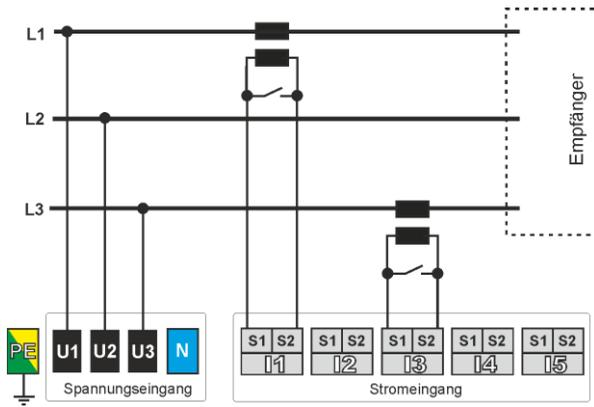
Abb. 29. Anschlussplan – 3-Phasen-3-Leitersystem, Aron-Messverfahren.
