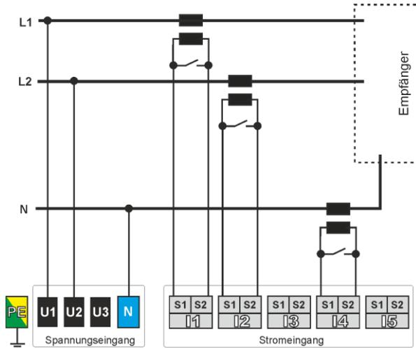
Abb. 26. Anschlussplan – Zweiphasensystem, Direktanschluss der Spannungen.
