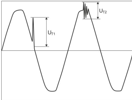
Abb. 36. Methode zur Bestimmung der transienten Amplituden.
