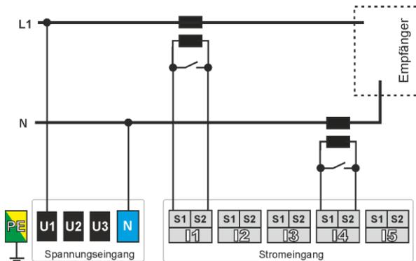
**Abb. 25. Anschlussplan – Einphasensystem, Direktanschluss der Spannungen.**
