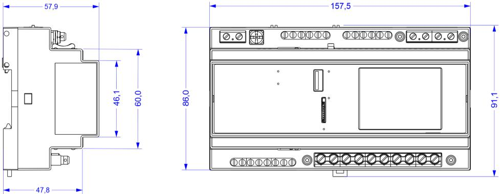
**Abb. 4. Außenabmessungen des Analysators (in Millimetern).**
