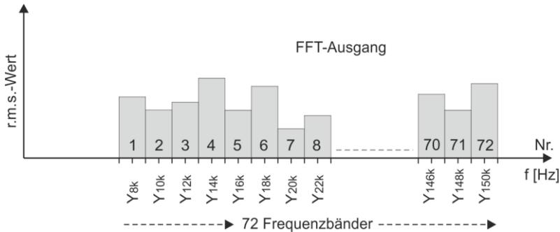
**Abb. 35. Frequenzbänder bei der Messung des 9-150-kHz-Bandes.**
