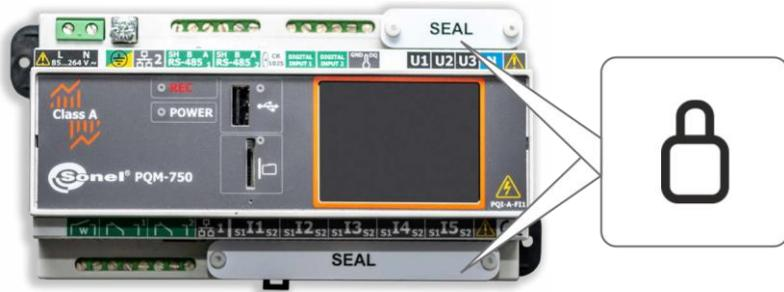
Abb. 7. Plombierung der Messeingänge.
