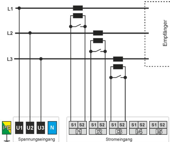
Abb. 28. Anschlussplan – 3-Phasen-3-Leitersystem, Direktanschluss der Spannungen.
