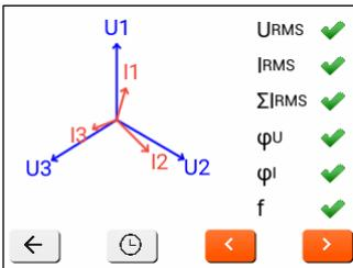
Die angegebenen Indikatoren sind fortlaufend gekennzeichnet als:  $U_{RMS}$ ,  $I_{RMS}$ ,  $\Sigma I_{RMS}$ ,  $\varphi_U$ ,  $\varphi_I$ ,  $f$ .
