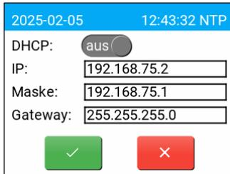
Standardmäßige Netzwerkeinstellungen nach Abb. 12 können durch Interaktion mit den Feldern geändert werden. Durch Drücken des DHCP-Schalters kann der Benutzer DHCP ein- und ausschalten, also zwischen automatischer und manueller Adresskonfiguration wechseln. Bei aktiver DHCP-Option muss es im Netzwerk einen DHCP-Server geben, der den Geräten IP-Adressen zuweist. Die erhaltene IP-Adresse kann durch Auswahl von **NETZWERK** im Hauptmenü überprüft werden.
